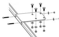
**FIXATIONS BARRE DE TOIT LONGITUDINALE POUR RAMPE MEGA-FLASH**
