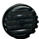
ALARME DE RECUL BK9 - 90 DB - 780 HZ
